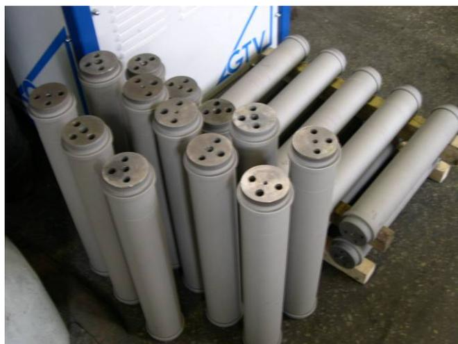
**Нанесено коррозионностойкое покрытие на концевые детали погружных насосов**
