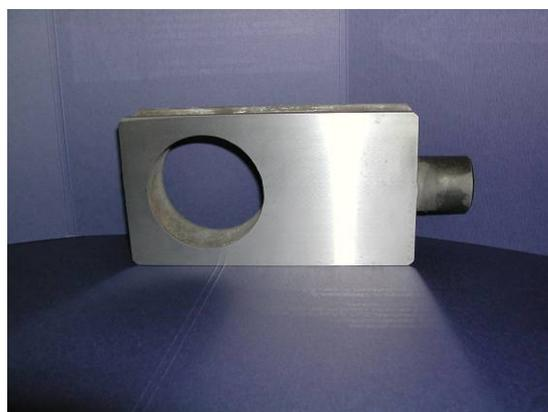
**Нанесено износостойкое покрытие на шибер задвижки**
