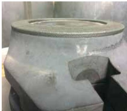
**Рисунок 1** – Внешний вид восстановленной лазерной наплавки контактной рабочей поверхности клина главной паровой задвижки Ду 300/250 Ру 250 типа S43 123-N-250-300/250 0010/2012 производства «MOSTRO Valves» (Чехия) энергоблока мощностью 225 МВт филиала «Черепетская ГРЭС» ОАО «ИНТЕР РАО – Электрогенерация»
