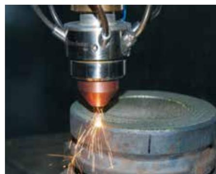
Рисунок 5 – Технологический процесс лазерной порошковой наплавки уплотняющей поверхности тарелки задвижки запорной арматуры ТЭС
