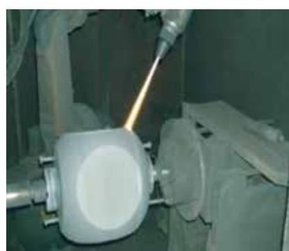
Рисунок 3 – Нанесение защитного покрытия методом высокоскоростного напыления на уплотнительную поверхность шара и шибера
