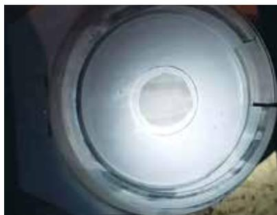
Рисунок 2 – Внешний вид растрескивания и отслоения слоя плазменной наплавки
