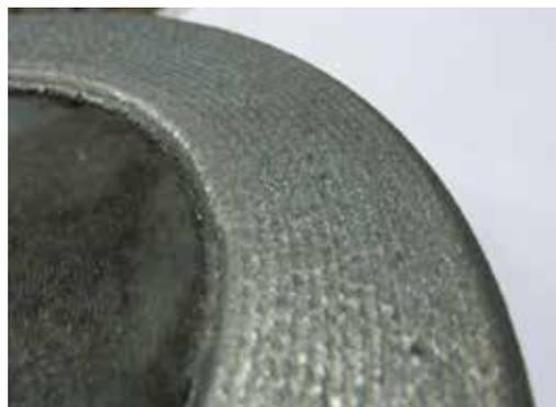
Рисунок 10 – Фотография выполненной кольцевой наплавки на тарелку DN 175: 5 слоев, ширина поля наплавки 35 мм, толщина наплавки 2,8–3,0 мм
