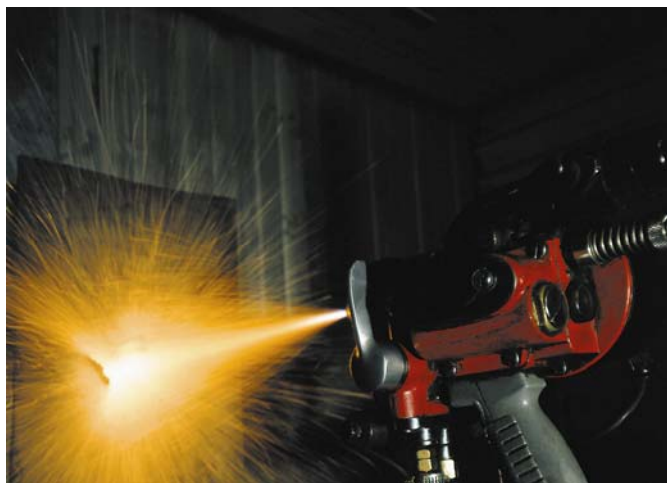
Процесс нанесения покрытия
